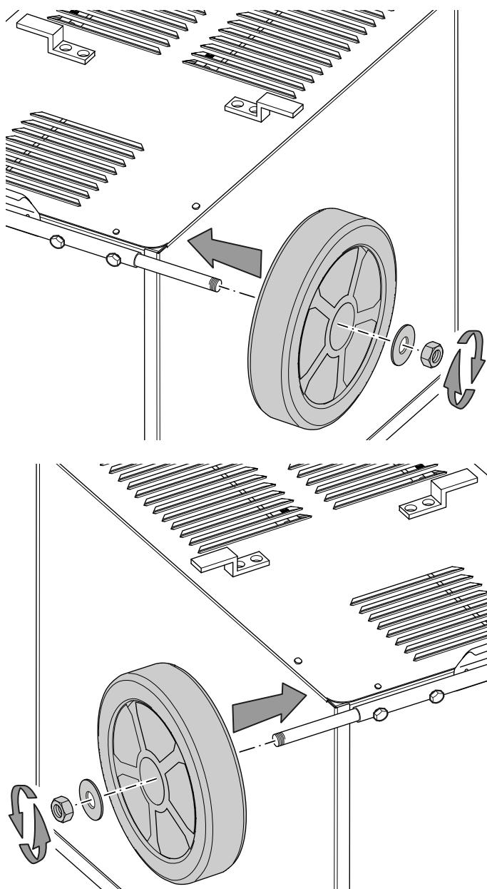
5. После монтажа установите устройство вертикально на колеса для транспортировки и ножки.
