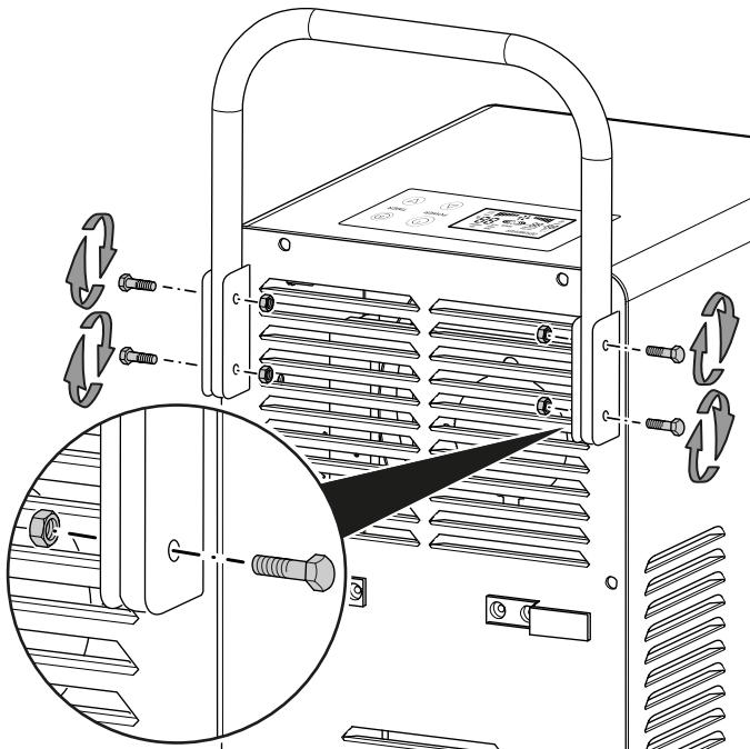
4. Проверьте прочность крепления ручки.
